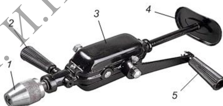
Рисунок 9.2. – Устройство ручной дрели
