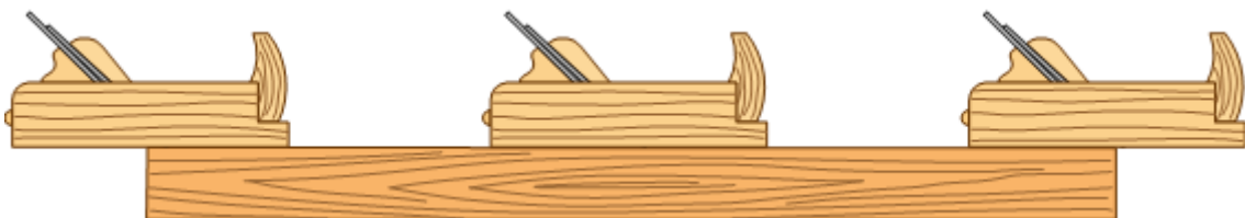
Рисунок 7.4. – Нажатие рубанка в процессе строгания
