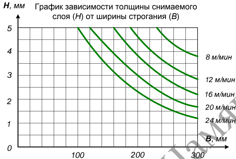
Рисунок 13.11. – График зависимости толщины снимаемого слоя ( H ) от ширины строгания ( B ) для мягких пород древесины
