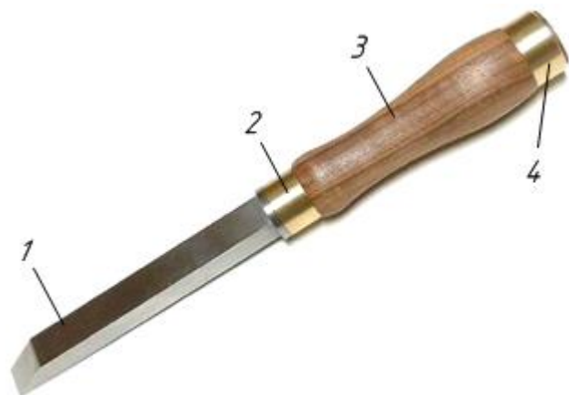
Рисунок 8.1. – Устройство столярного долота
