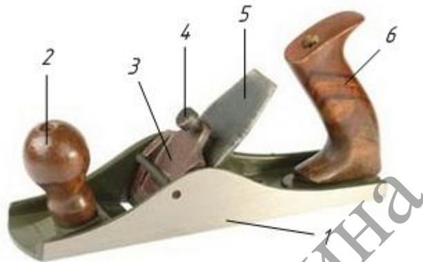
Рисунок 7.2. – Устройство металлического рубанка с одиночным ножом
