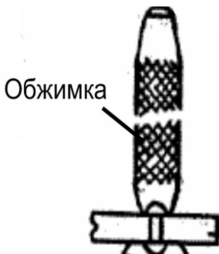
Рисунок 16.3 – Обжимка в работе
