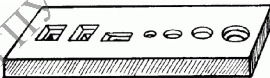
Рисунок 16.4 – Приспособление для получения закладных головок заклёпок
