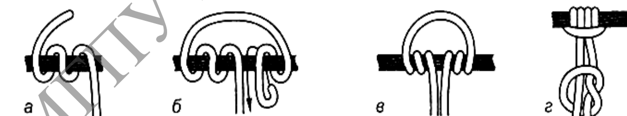
Рисунок 18. – «Схватывающий» узел одним концом
