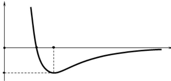
Рисунок. – Схематический график потенциальной энергии  $U(r)$  Леннарда-Джонса
