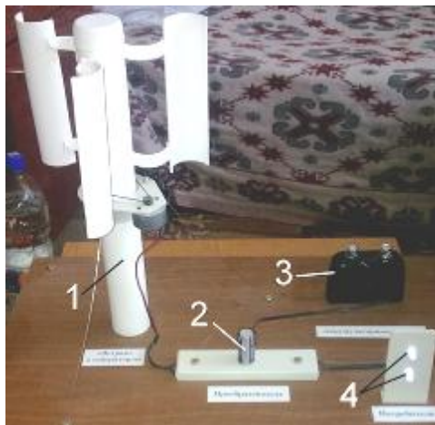
1 – ветряк-парус с генератором, 2 – преобразователь, 3 – аккумуляторные батареи, 4 – потребители
