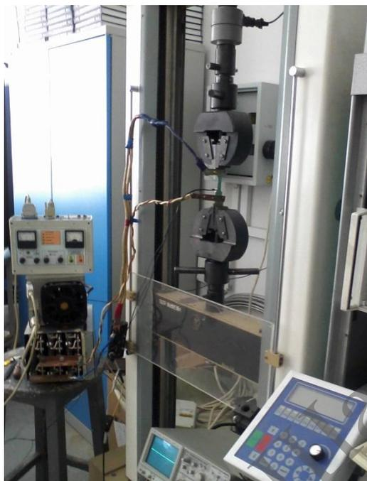
**Рисунок 1. – Специальный стенд для испытания образцов на разрыв с записью зависимости величины растягивающей силы от времени**
