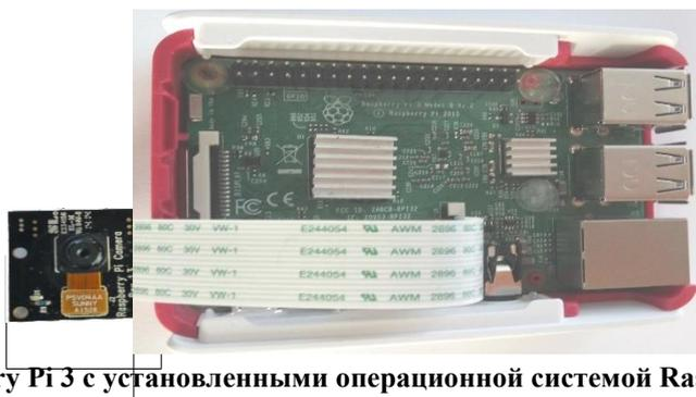
**Рисунок 2. – Raspberry Pi 3 с установленными операционной системой Raspbian и библиотекой OpenCV**
