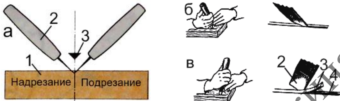
1 – заготовка, 2 – нож-косяк, 3 – трёхгранная полоска, 4 – двухгранная выемка а – схематичное изображение наклона инструмента по отношению к заготовке; б – надрезание; в – подрезание
