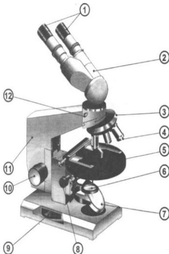
1 – окуляры; 2 – бинокулярная насадка; 3 – револьверное устройство; 4 – объектив; 5 – предметный столик; 6 – конденсор; 7 – зеркало; 8 – рукоятка перемещения кронштейна конденсора; 9 – рукоятка тонкой фокусировки; 10 – рукоятка грубой фокусировки; 11 – тубусодержатель; 12 – винт для крепления насадки
