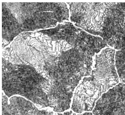
Рисунок 5.7. – Заэвтектоидная сталь с 1,2 % С (× 500) – перлит и цементит; травление 4%-ным раствором азотной кислоты
