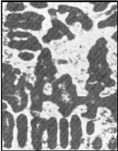
Рисунок 9.5. – Микроструктура однофазной оловянистой бронзы (5 % Sn). Травление хлористой меди и аммония; x 250
