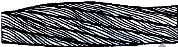
Рисунок 10.11. – Местное увеличение диаметра каната
