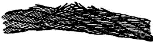
а) в нескольких прядях каната; б) в двух прядях в сочетании с местным износом Рисунок 10.4. – Обрывы проволок в зоне уравнильного блока
