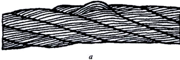
а) – в одной пряди; б) – в нескольких прядях Рисунок 10.10. – Выдавливание проволок прядей
