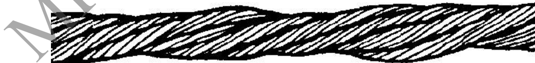
Рисунок 10.5. – Местное уменьшение диаметра каната на месте разрушения органического сердечника
