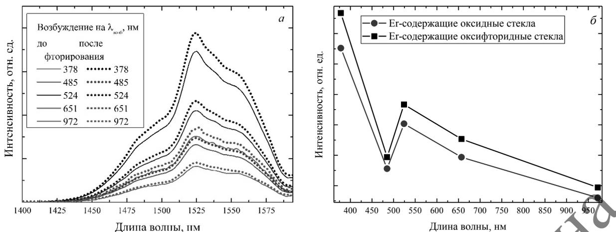
Рисунок 2 – Спектры ИК-люминесценции (а) и зависимость её интегральной интенсивности (б) от длины волны возбуждения для стекла состава (мол. %)  $5,0\text{Er}_2\text{O}_3-5,0\text{Y}_2\text{O}_3-30,0\text{Al}_2\text{O}_3-60,0\text{B}_2\text{O}_3$
