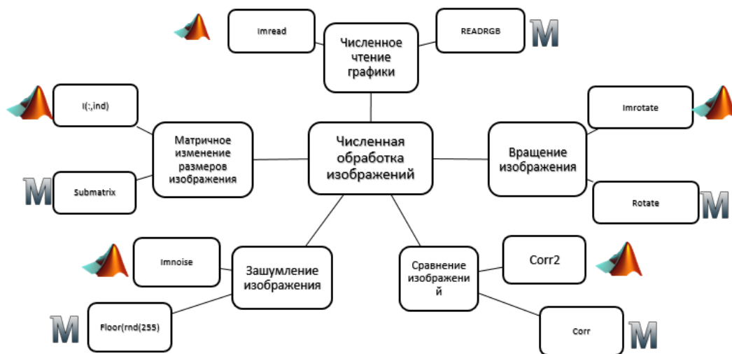
Рисунок 2 – Ментальная карта основных методов MathCAD и MATLAB по обработке изображений
